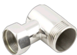
арт. 00-1505-0134 Уголок переходной н/ж "Сунержа" G 1" нар.р / G 3/4" н.г. Материал: Полированная нержавеющая сталь марки 08X18H10
