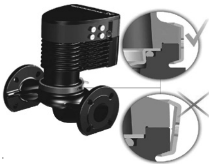
Рис. 16 Закрепление головной части насоса на корпусе насоса
